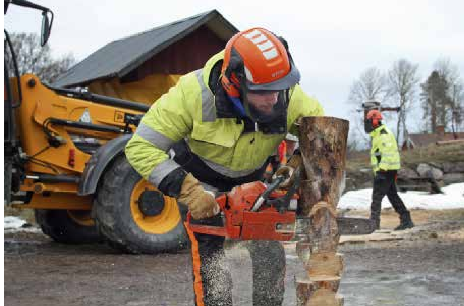
➔ Att träna på att såga riktskär går utmärkt hemma på gårdsplanen. Och en lagom stor stubbe kan som synes användas flera gånger om. Här är det kursdeltagaren Johathan Ekeröth som håller i sågen.
